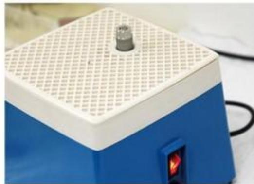
3. Закрепите шлифголовку на валу, повернув установочный винт по часовой стрелке с помощью шестигранного ключа.
