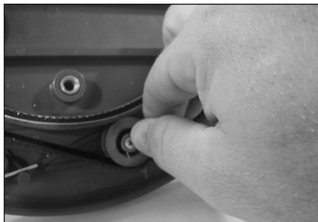
Поднимите рычаг натяжения №10 и снимите приводной ремень с синего опорного ролика №4.
