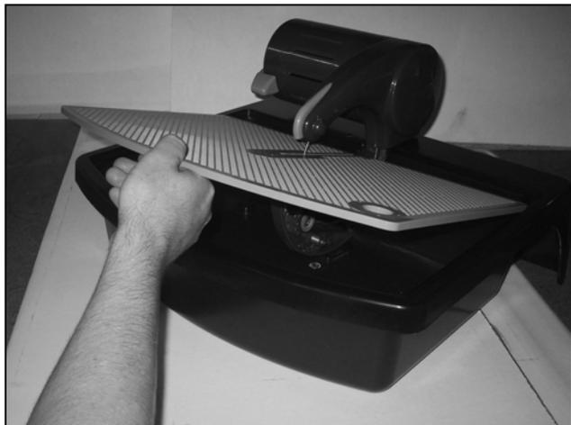
Плавнo установите рабочую поверхность на резервуар.
