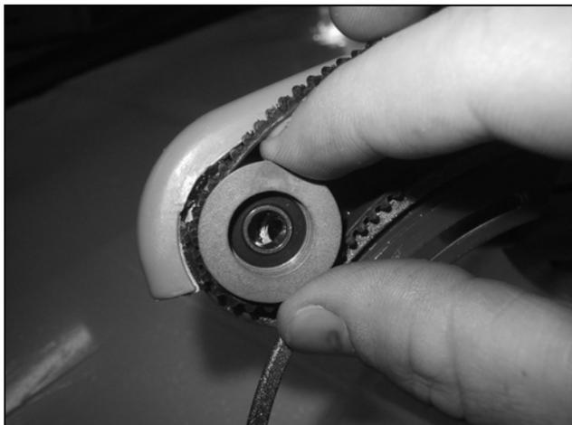
Оберните приводной ремень №9 вокруг синего опорного ролика №1 и установите ролик. Вставьте болт и затяните отверткой.
