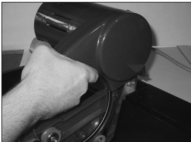
Снимите нижнюю крышку и установите пилу в паз основания (резервуар для воды).
