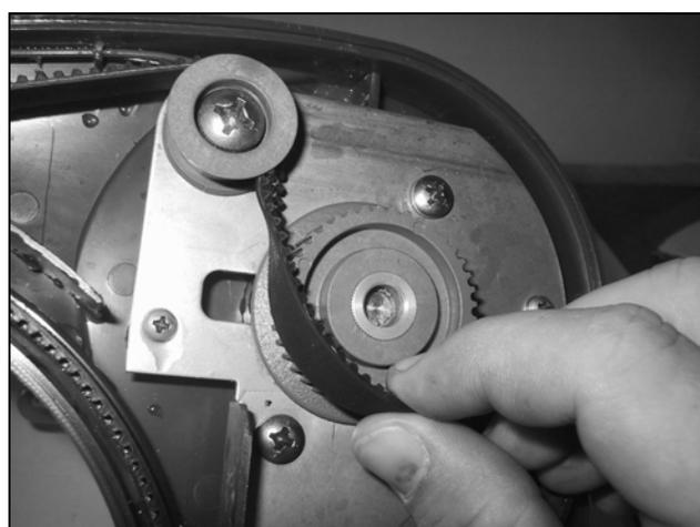
Снимите приводной ремень с приводного ролика №8.
