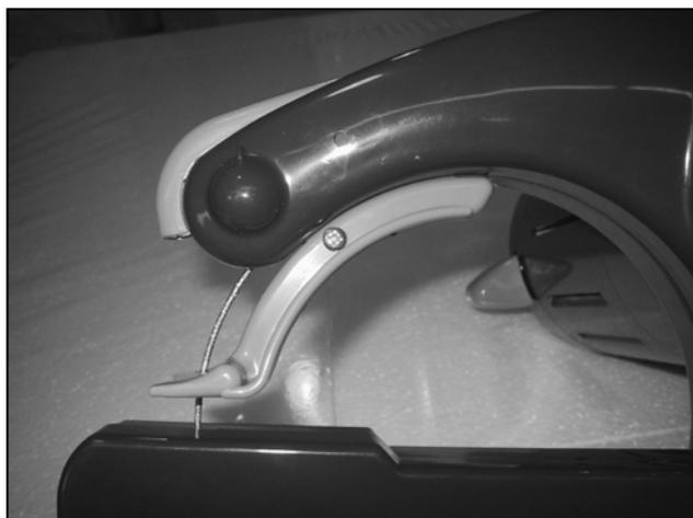
Стабилизатор поставляется с болтом и гайкой. Закрутите болт таким образом, чтобы стабилизатор свободно двигался.
