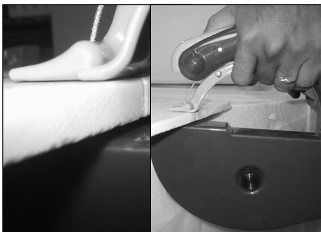
Опустите стабилизатор в направлении основания пилы таким образом, чтобы был небольшой зазор между плоскостью стабилизатора и обрабатываемым
