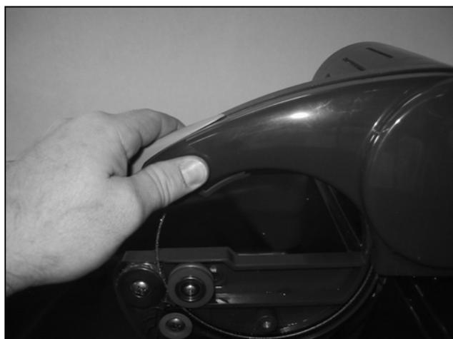
Для того, чтобы закрепить крышку, соедините и зафиксируйте передние части корпуса пилы.
