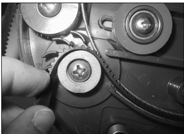
Аккуратно снимите приводной ремень с синего опорного ролика №5.
